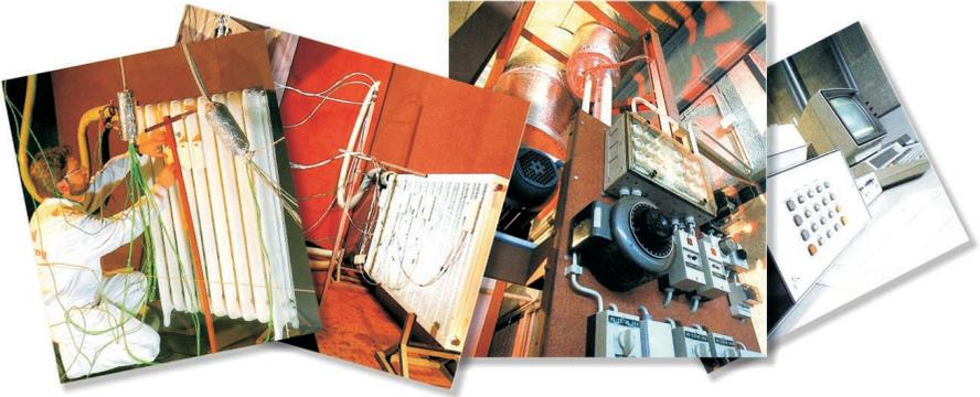
Abb. 12: Der Minol Messtechnik Heizkörperprüfstand nach DIN 4704. Hier werden die exakten Wärmeübergangswerte für alle Heizkörper und Heizkostenverteiltertypen gemessen.
