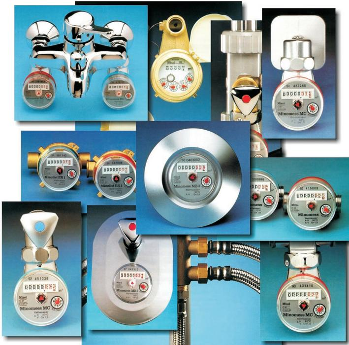
Abb. 20: Verschiedene Bauformen von Wohnungswasserzählern mit Badewannenzähler, Zapfhahnzähler, Waschtischzähler, Ventilzähler, Unterputzzähler, Universalzähler. Es handelt sich immer um Einstrahlzähler als Trockenläufer.
