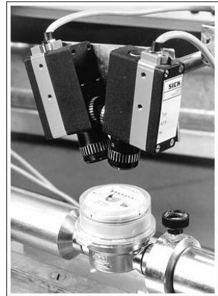
Abb. 1: Jeder Wasser- und Wärmezähler wird bei der Eichung oder Beglaubigung auch einzeln auf seine Funktionsfähigkeit geprüft.
