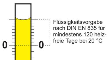
Abb. 1: Alle Heizkostenverteilern nach dem Verdunstungsprinzip haben eine Überfüllung für den Sommer.
