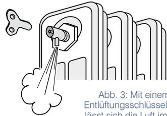
Abb. 3: Mit einem Entlüftungsschlüssel lässt sich die Luft im Heizkörper ganz einfach ablassen.
