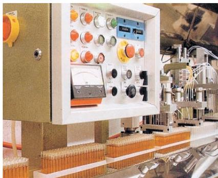
Abb. 13: Ampullenfüllstation bei Minol Messtechnik. Für Heizkostenverteiler nach dem Verdunstungsprinzip werden hier jährlich mehrere Millionen Ampullen mit höchster Präzision vollautomatisch befüllt.
