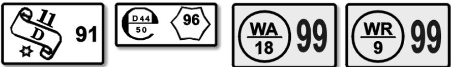
Abb. 16: Eichmarken (links) oder Beglaubigungsmarken (Mitte und rechts) zeigen, dass die eingebauten Wasserzähler den Vorgaben des Eichgesetzes entsprechen (Musterbeispiele). Jeder zu Abrechnungszwecken verwendete Zähler muss eine dieser Marken besitzen.
