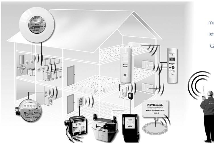
Abb. 1: Mit einem modernen bidirektionalen Funksystem ist nicht einmal mehr das Betreten des Gebäudes zur Ablesung erforderlich.
