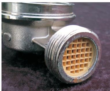
Abb. 23: Siebe im Einlauf von Wasserählern verhindern des Eindringen grober Schmutzpartikel. Kalkablagerungen können sie aber auch nicht verhindern.
