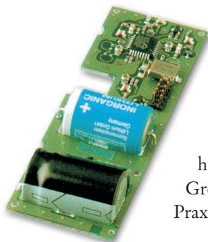
Abb. 3: Das Sende- und Empfangsmodul Minotel plus für den Heizkostenverteiler Minometer 5.
