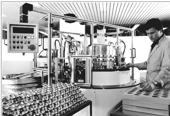
Abb. 6: Wasserzählerherstellung bei Minol Messtechnik in Mulda. Die jährliche Produktionskapazität liegt bei rund 250.000 Geräten.
