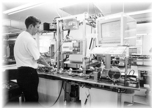
Abb. 14: Prüfung von Wasserzählern auf Genauigkeit entsprechend den Vorgaben des Eichgesetzes.
